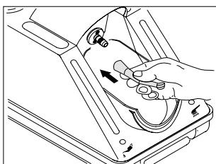
Násadec nasaděte na ošetřovací nástavec až na doraz, otvorem spreje dolů. Uzavřete kryt a odpadní nádobku.
