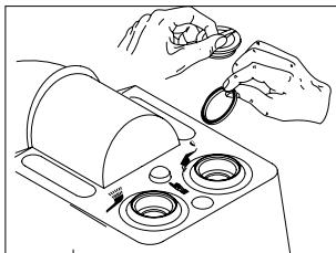
Odšroubujte oba uzávěry a odstraňte obě transportní těsnění (porucha funkčnosti)!
