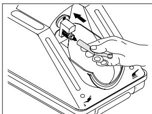
Turbínu s rychlospojkou nasadte na doraz sestavy adaptérů otvorem spreje dolů. Uzavřete kryt a odpadní nádobku.
