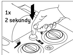
Stiskněte na 2 sekundy programové tlačítko. Po uplynutí ošetřovacího procesu otevřete kryt.
