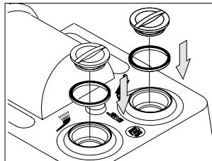
Do každého plnicího otvoru vložte těsnění.
