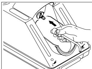
Adaptér T1 nasaděte na ošetřovací nástavec výstupním otvorem dolů.
