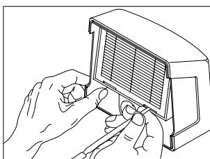
Soustavu filtrů vyjměte pomocí vhodného předmětu.
